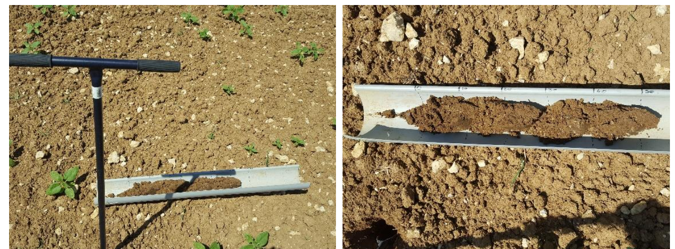
Photo 20 : sondage pédologique réalisé sur la zone d'implantation potentielle
