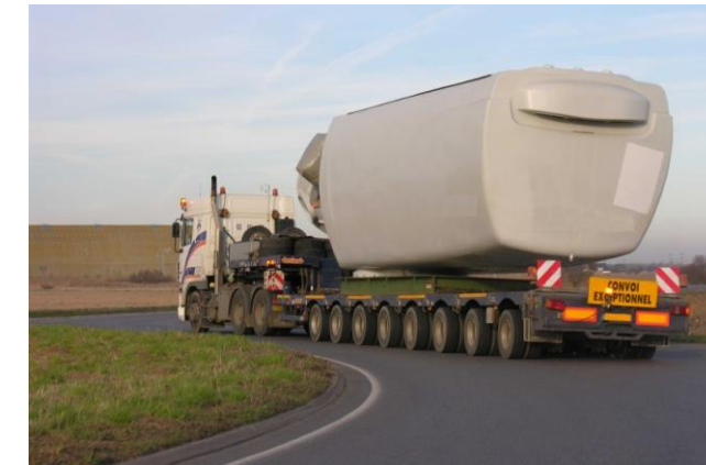
Transport de la nacelle
